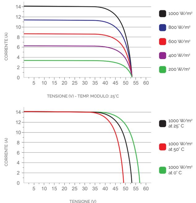
1. STC: (Standard Test Condition) Irraggiamento 1000W/m<sup>2</sup>, Temperatura Modulo 25°C, Massa d'aria 15
